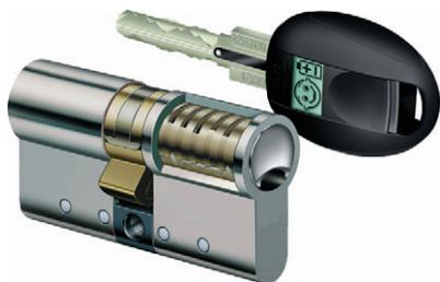
In geschlossenem Zustand ist der Zylinderkern durch die Stifte blockiert. Beim Einstecken des Schlüssels werden die Stifte in eine Position bewegt, die es ermöglicht, den Zylinderkern und damit die Schließnase zu drehen.
